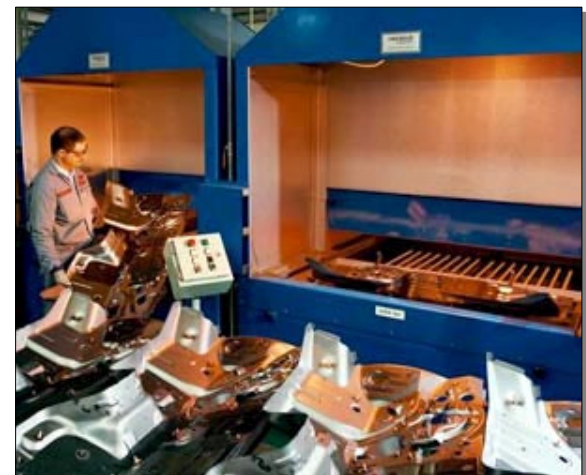
Trattamento dei pannelli fonoisolanti, prima della loro installazione
