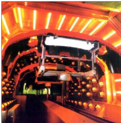
Trattamento vernice su paraurti verniciati
