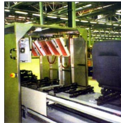
Riscaldamento delle zone in cui verranno applicate le modanature e riscaldamento delle modanature stesse
